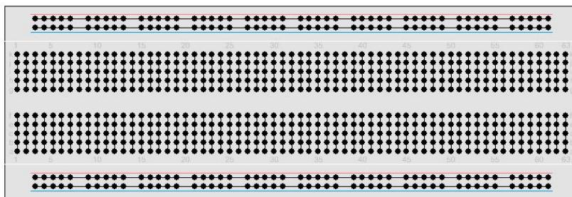
Die oberen und unteren beiden Reihen sind waagerecht über die gesamte Breite des Boards miteinander verbunden. Sie sind für die Stromversorgung vorgesehen (rot = Plus, blau = Minus). In den mittleren Reihen sind jeweils 5 Kontakte wie dargestellt miteinander verbunden.
