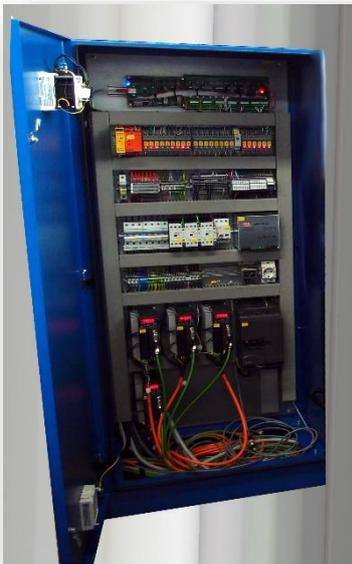
Die Steuerung befindet sich in einem Schaltschrank, oder, je nach Ausführung, im Steuerungsgehäuse. Die Steuerung enthält im Wesentlichen die Lampen zur Anzeige der Schutzkette, sowie die Steuer- und Hauptstromkreise (elektrische Schutz-einrichtungen, Schütze usw.).
