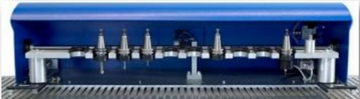
Dabei ist es von Vorteil den Werkzeugwechsel automatisiert durchzuführen. Der Werkzeugwechsler besteht aus einem Aufnahmesystem für benötigte Fräsköpfe. Das CNC- Fräsportal enthält in der Steuerung definierte Koordinaten, anhand derer es das jeweils benötigte Werkzeug anfahren und wechseln kann.
