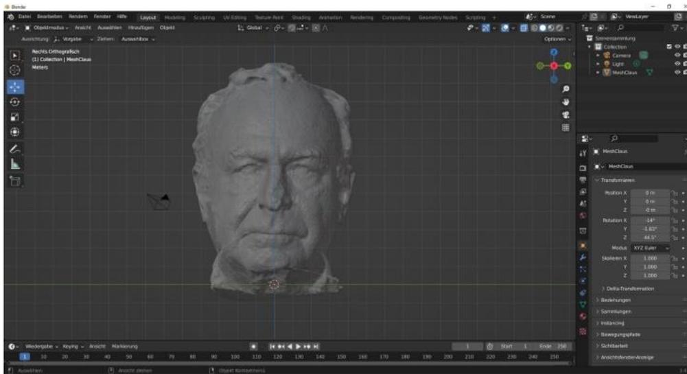
Nach dem das Objekt ausgerichtet ist, ist es jedoch leider noch nicht „druckreif“. Denn es hat sicher noch Löcher oder Überschneidungen. Dies kann gut mit MeshLab bereinigt und geschlossen werden.
